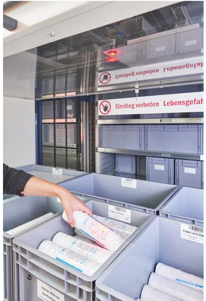
Verwechslungsfreie Identifikation des angeforderten Artikels durch das Hänel-Pick-o-Light-Vario.
