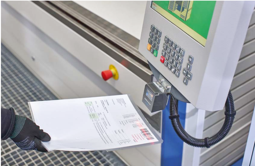
Nach dem Scannen des Auftrags wird der Kommissioniervorgang gestartet, und alle relevanten Multifunktions-Container werden im Liftverbund vorpositioniert.
