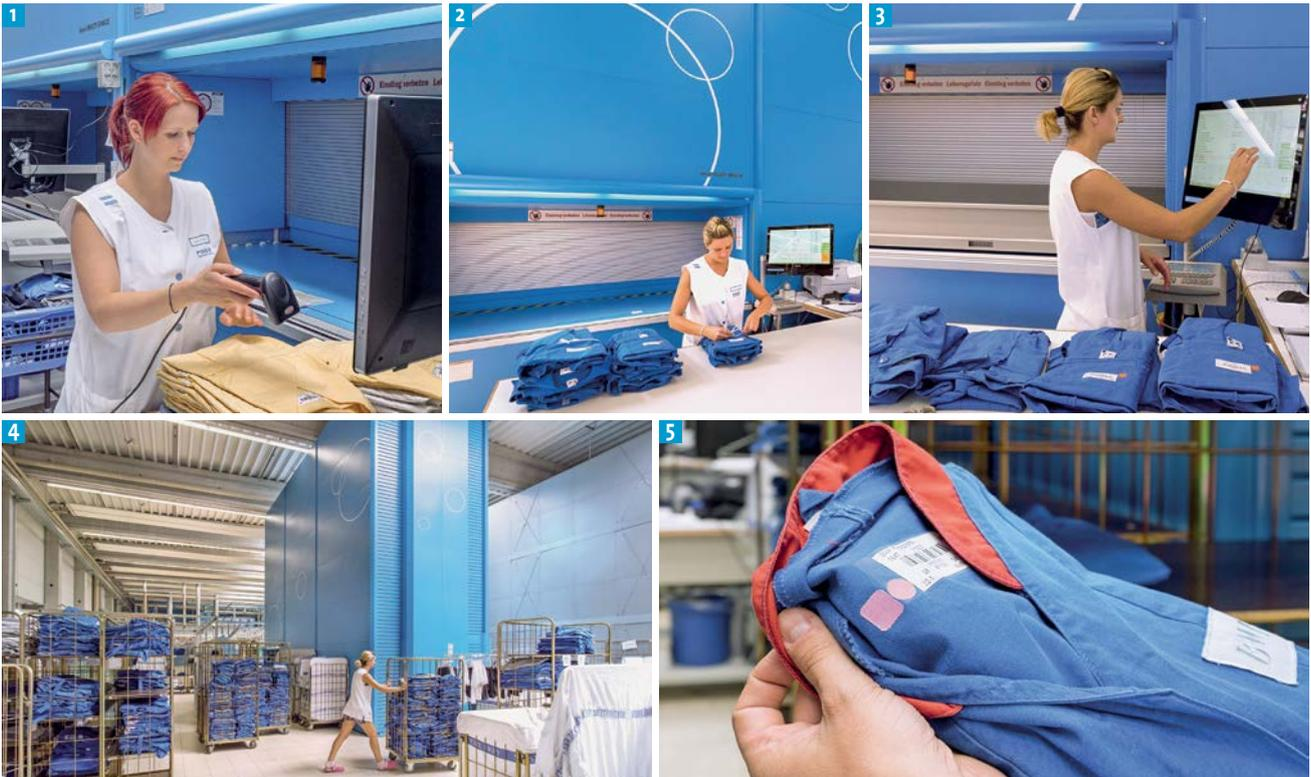
**1** Durch Scannen des Strichcodes wird der jeweils richtige Container zur Entnahmestelle transportiert.
