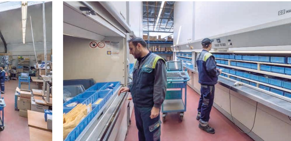
mit dem Pick-by-Light Verfahren fehlerhafte Pickvorgänge vermieden. Nach einem Pickvorgang wird mittels der grünen Taste die nächste Position angefahren und so die Kommissionierung beziehungsweise Einlagerung abgearbeitet.
