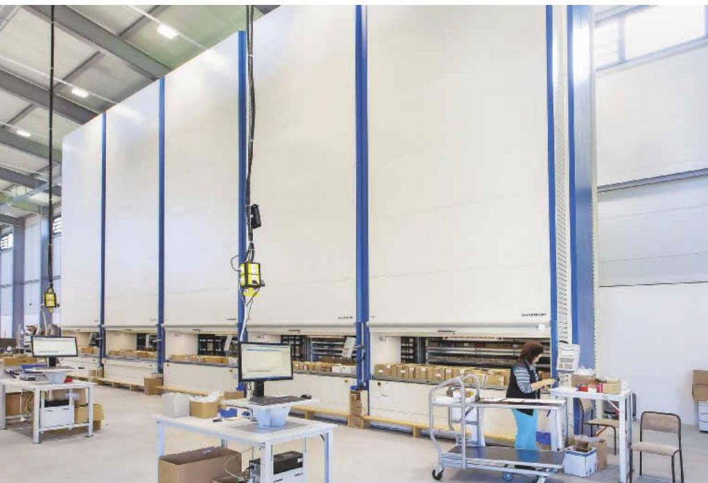
Durch die kompakte Bauweise der Lean-Lifte kann bei Ausnutzung der Raumhöhe eine große Menge Platz gespart werden. (Foto: Hänel)
